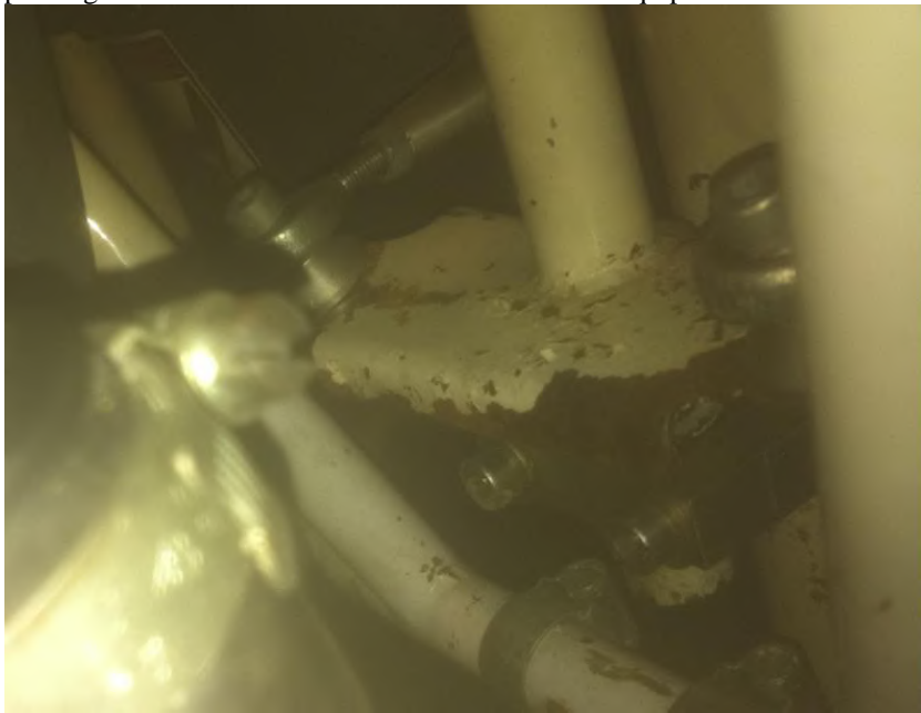
Photo d'un guignol de direction déformé d'ULM SENSATION
