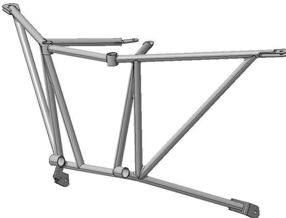
Image CAO du bâti moteur de l'ULM SENSATION
