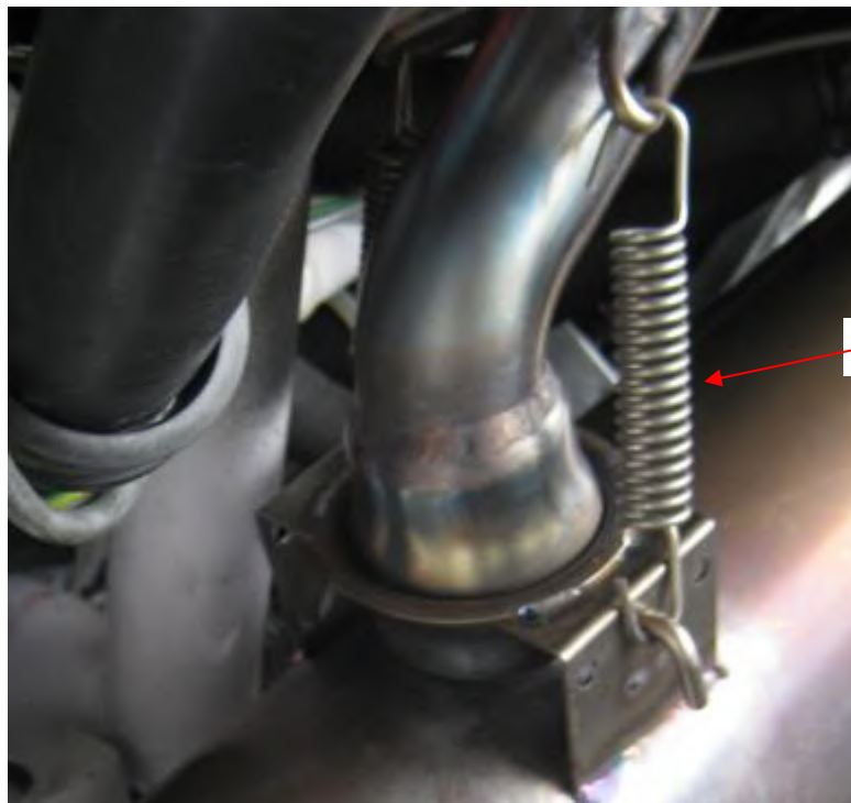
Vue de la liaison pipe / silencieux
