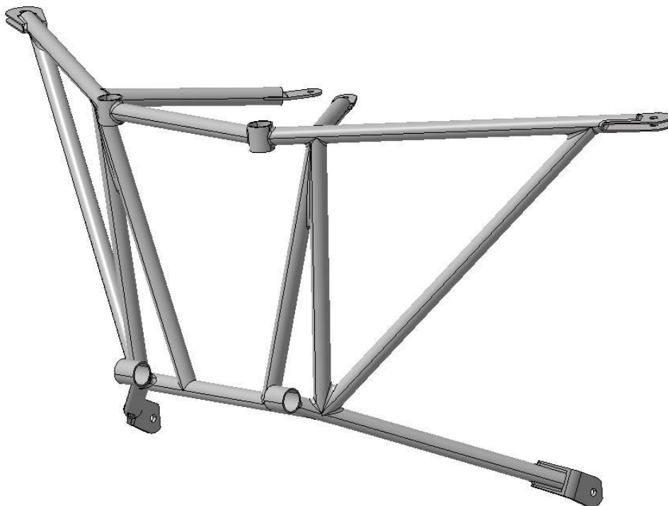
Image CAO du bâti moteur de l'ULM SENSATION
